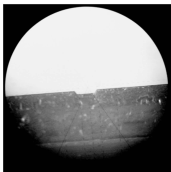
图6 工具显微镜测量的微通道轮廓
